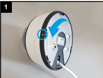
1 Feststellschraube lösen und Montageplatte abnehmen.
